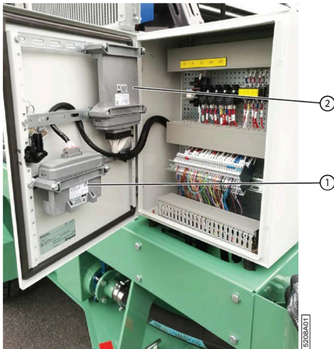
Fig. 122: Emplacement des contrôleurs
