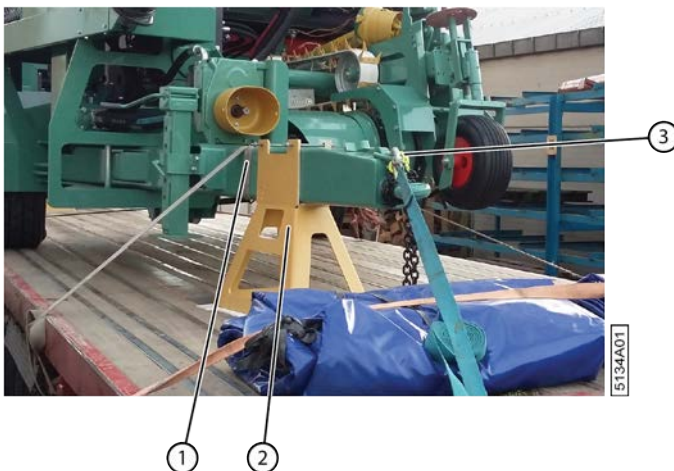
Fig. 44: Fixer la machine sur le camion (avant)
