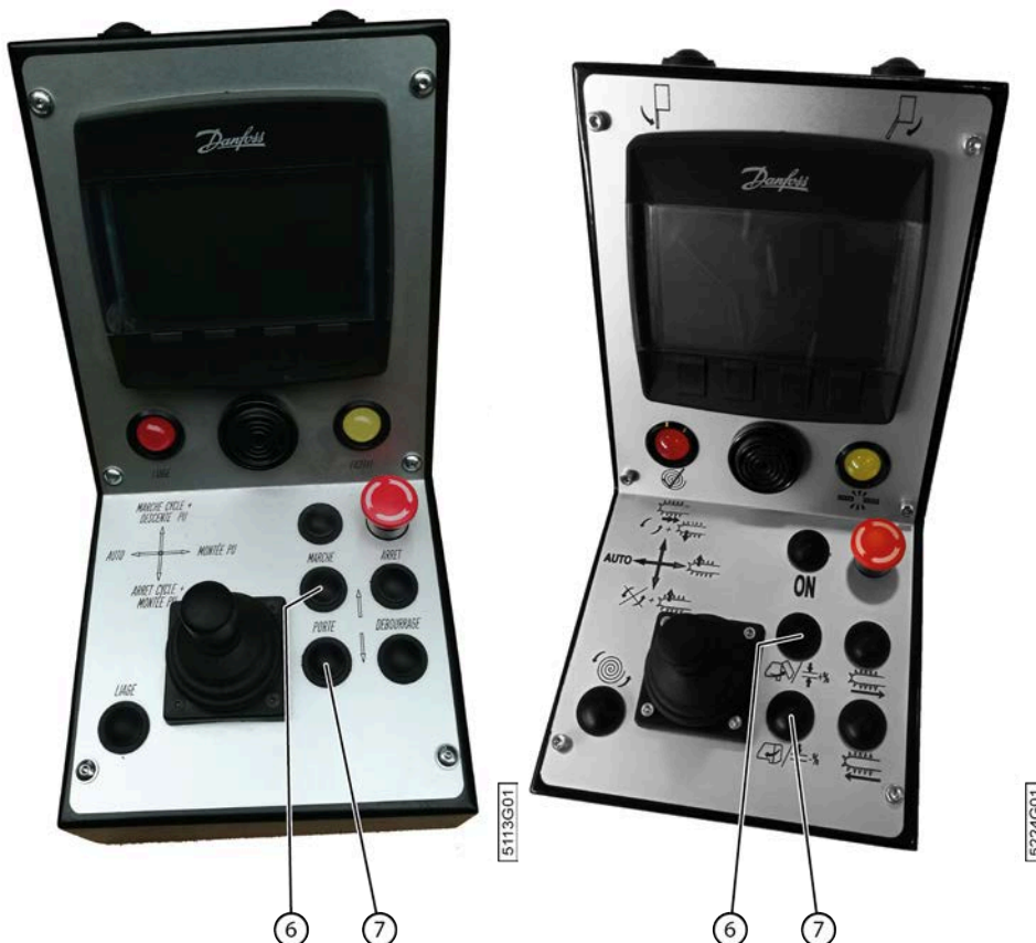
Fig. 75: Régler l'épaisseur de la nappe de lin avec la console de commande
