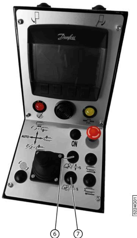
Fig. 74: Ouvrir et/ou fermer la cage avec la console de commande
