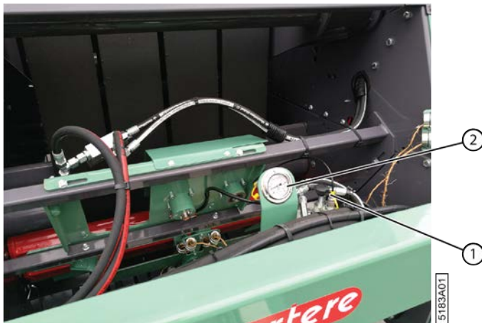
Fig. 89: Régler la pression de serrage dans la cage
