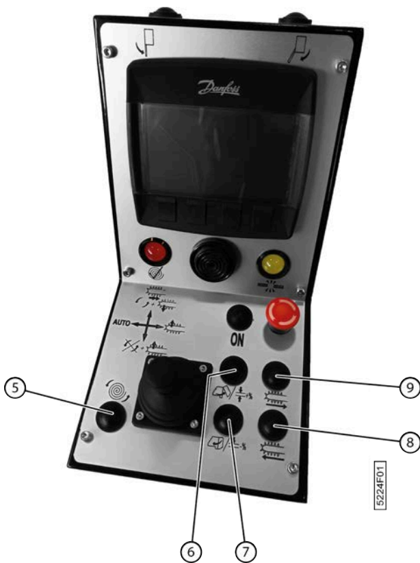
Fig. 73: Vérifier le fonctionnement des boutons de la console de commande
