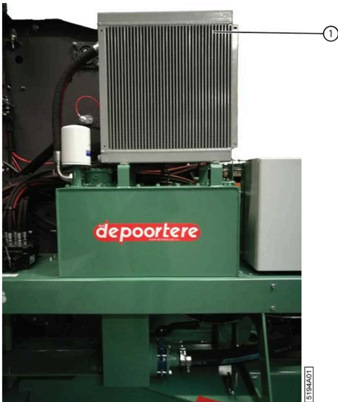
Fig. 102: Nettoyer le radiateur de l'huile hydraulique
