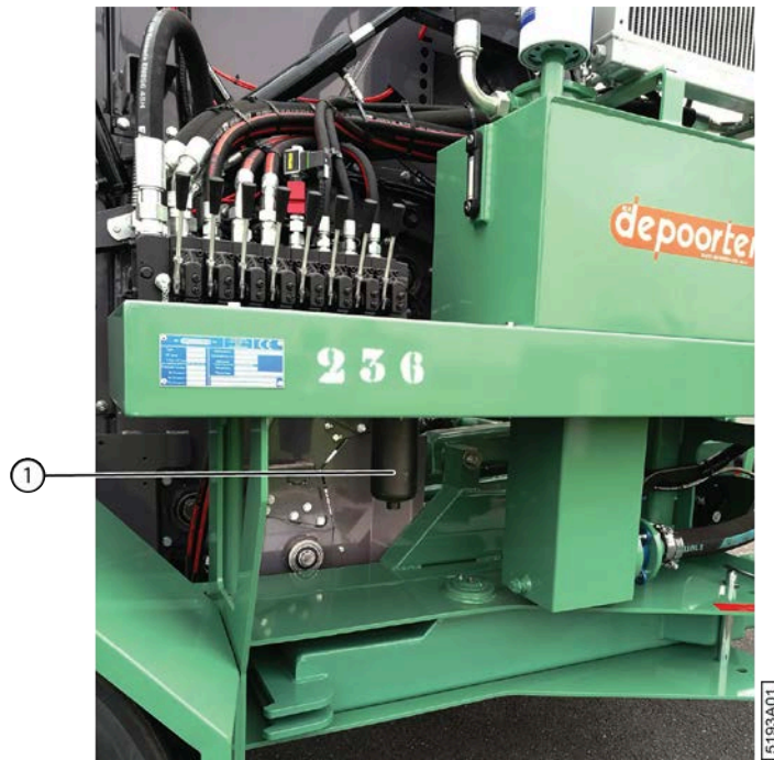
Fig. 101: Remplacer le filtre haute pression
