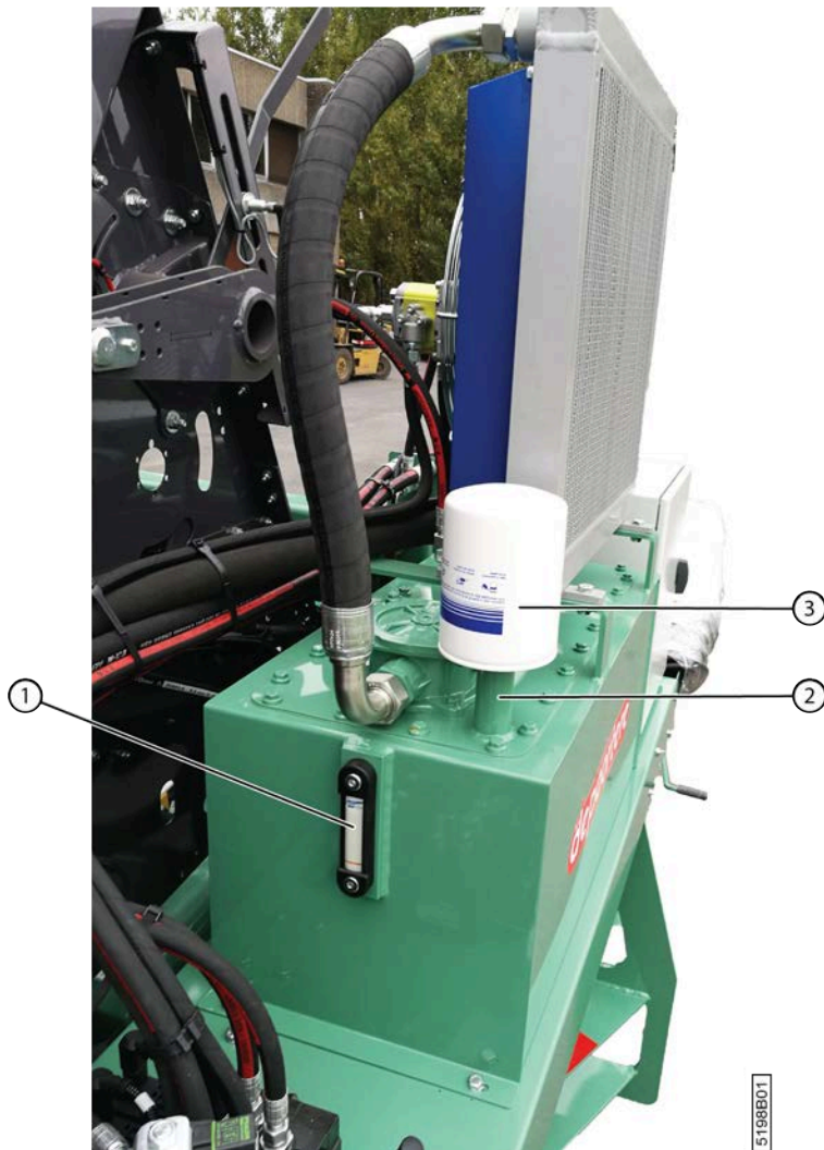
Fig. 108: Changer l'huile hydraulique
