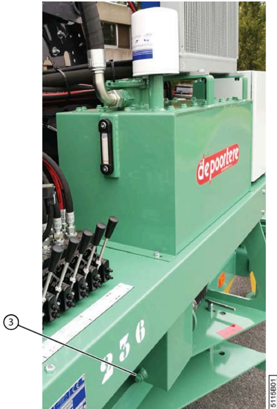
Fig. 143: Vidanger le réservoir hydraulique
