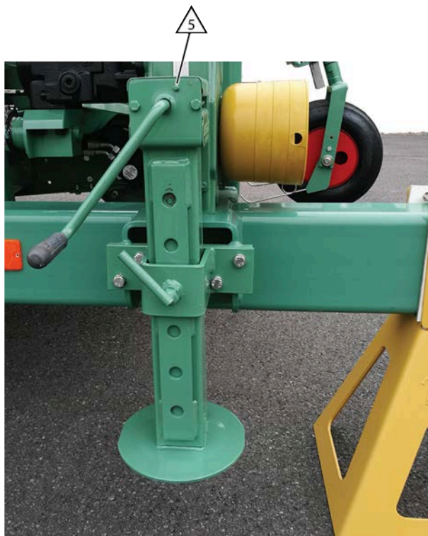
Fig. 119: Lubrifier la béquille mécanique
