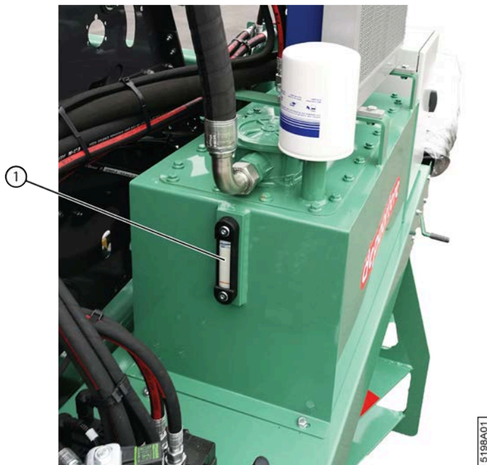
Fig. 107: Niveau huile hydraulique
