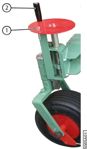
Fig. 81: Régler la hauteur du pick-up
