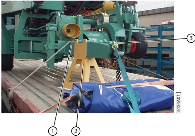
Fig. 41: Fixer la machine sur le camion (avant)
