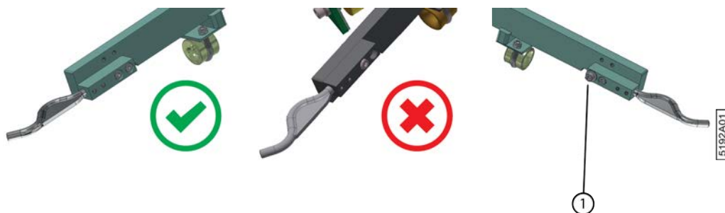
Fig. 138: Vérifier l'emplacement du bloc du doigt
